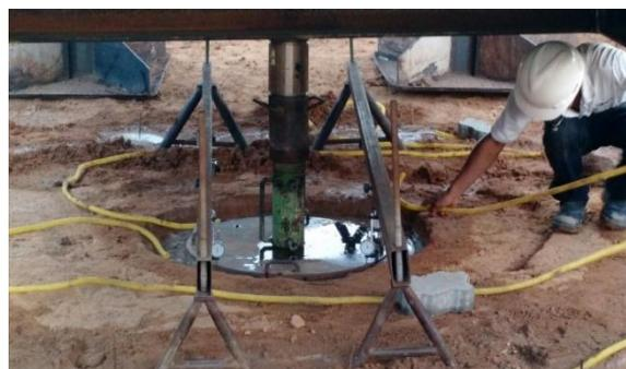
Figura 7. Indução de inundação sob a placa no ensaio PCE02-C1
