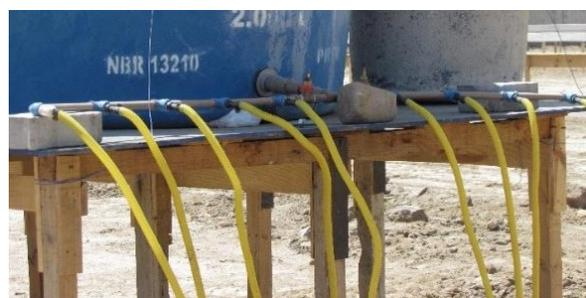
Figura 5. Reservatório de água com dispositivos para inundação das escavações radiais.
